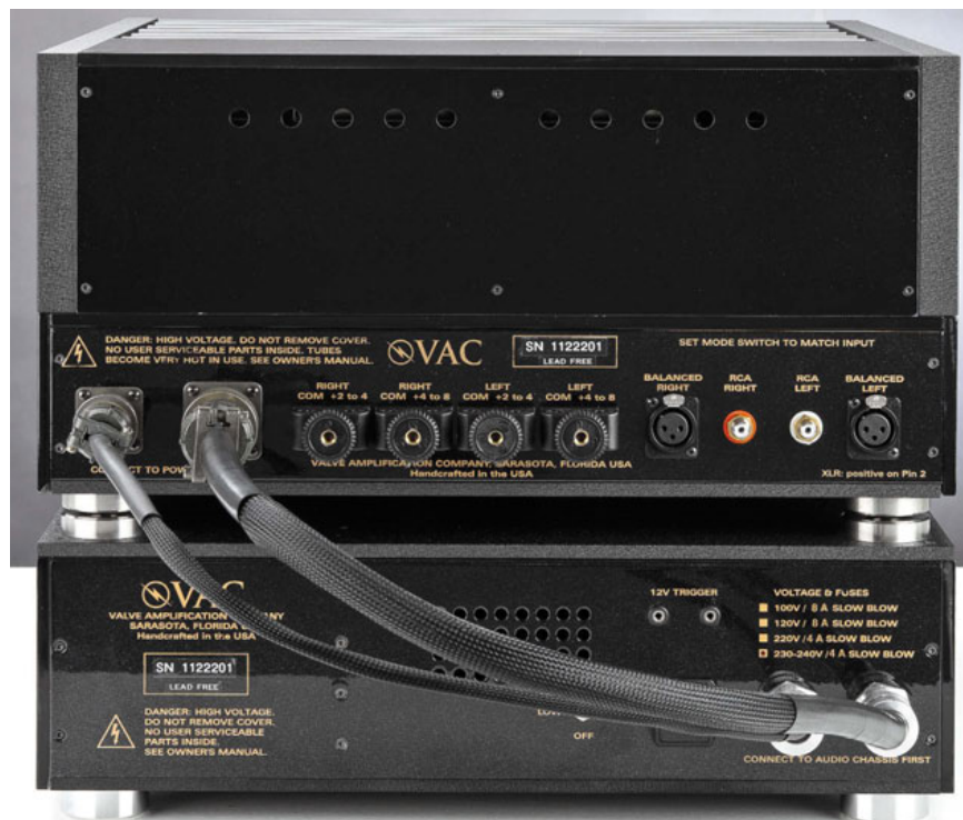
Ottimi i connettori Cardas per il collegamento dei diffusori. Notare i due cavi che distribuiscono le alimentazioni.
