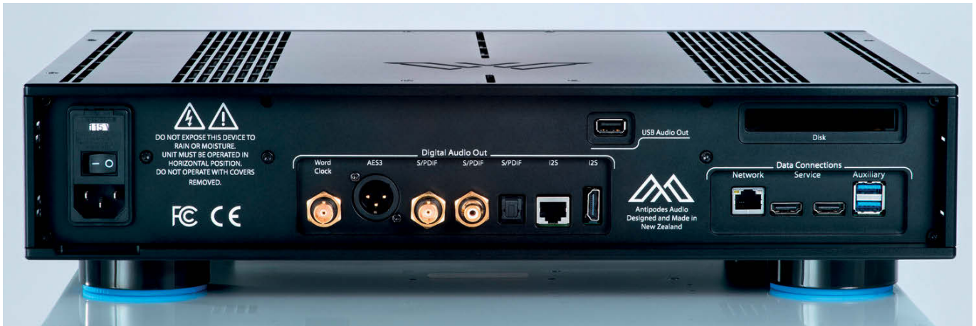
Figura 3. Pannello posteriore del K22. Sono disponibili, nella sezione Digital Audio Out (al centro) ben otto uscite diverse, di tutti i tipi, compresa un'uscita per il Clock da inviare al DAC per la sincronizzazione. Sulla destra sono presenti le prese per la connessione dati, tra cui la presa Ethernet e un paio di USB, da utilizzare per i dispositivi di archiviazione (per l'uscita audio ce n'è una separata). Sopra a queste vi è uno slot per inserire un hard disk SSD.
