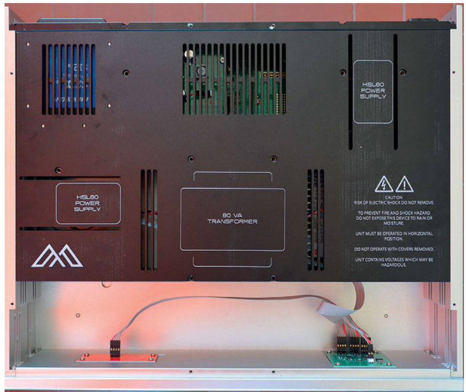
Figura 4. Vista dell'interno. Tolto il pesante coperchio superiore, si trova un secondo coperchio interno, sotto il quale si trovano vari scompartimenti, separati tra loro, per schermare le varie sezioni.
