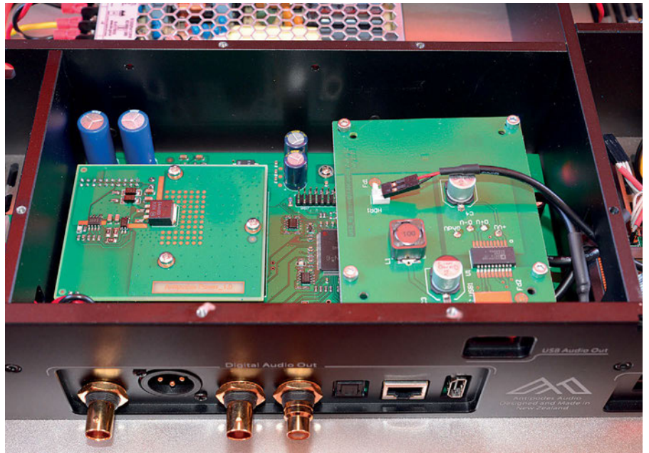
Figura 6. Particolare della sezione Digital Audio Out. Le due schedine superiori sono, la prima a sinistra, per l'uscita isolata USB, l'altra per la stabilizzazione della tensione. Sotto, nella scheda più grande, risiedono gli altri circuiti, tra cui una sorgente di clock di elevata qualità per sincronizzare i dati in uscita.
